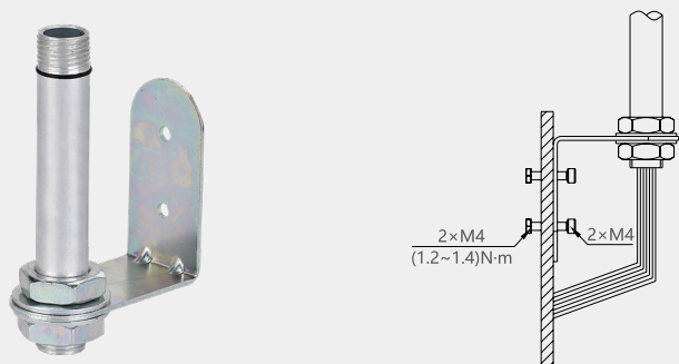
图8 NDT1-52侧向式安装示意图
