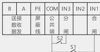
图11 二次端子接线图(N相右置产品)
