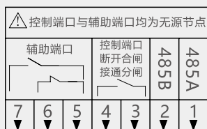
图12二次端子接线图(N相左置产品)
