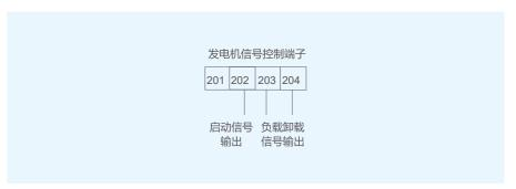
至 201、202 为一组常闭端子,当常用电源正常,此端子处于断开位置,当常用电源故障,经过控制器程序中设置的延时时间后,端子处于闭合状态,输出发电机启动请求信号。 当常用电源主电路断开后,203、204 端子内部干接点输出闭合的无源信号,进行负载卸载。
