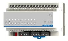
MX-4FD3是我司自主研发的KNX系列调光模块产品之一,具有4路前向沿可控硅调光输出功能,调光输出可接白炽灯、卤素灯、前向控电子变压器等阻性负载可调光源,广泛应用于智能照明、智能家居等控制领域,支持标准的KNX通讯协议,通过EIB/KNX总线可与其他KNX设备及负载一起安装成为控制系统,提供产品库文件,可用专业设计工程软件ETS5进行编程。
