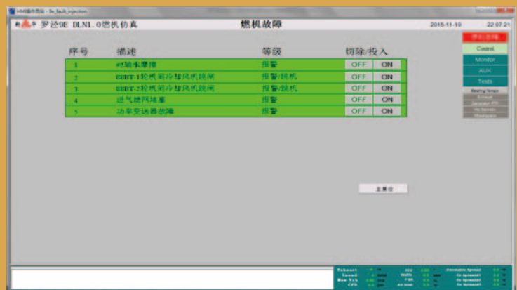
图3、燃机故障注入画面
